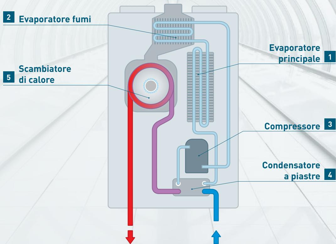
L'EFFICIENZA È COSÌ ELEVATA CHE I FUMI DELLA COMBUSTIONE ESCONO ALLA TEMPERATURA DI 10°C CIRCA
