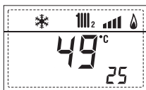
26. Affichage thermostat sécurité avec carte ZONE MIX 2 (entrée S1) respectivement ON et OFF
